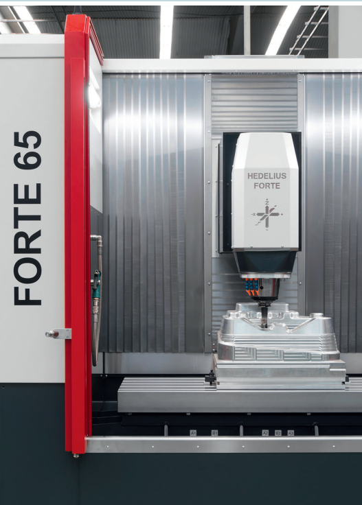
2 3-Achs-BAZ mit hoher Flächenproduktivität: Blick in den Arbeitsraum einer kompakten Forte 65 Single 1320 (© Hedelius)
